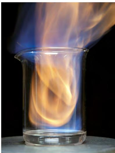
Bei der Verbrennung von Methanol zu Kohlendioxid und Wasser entsteht eine bläuliche, kaum rußende Flamme.
