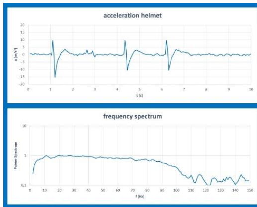
Abb. 3 Die Analyse-Software visualisiert die vom Helm-Sensor gemessenen Schwingungen in Echtzeit. Die obere Linie zeigt das Beschleunigungssignal, die untere die Stärke der Schwingungen bei verschiedenen Frequenzen.
