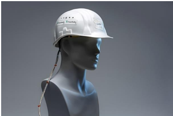
Abb. 1 Der Piezo-Elektret-Wandler ist unauffällig im inneren Befestigungsriemen des Helms eingearbeitet. Das Foto zeigt einen Demonstrator der Technik.
