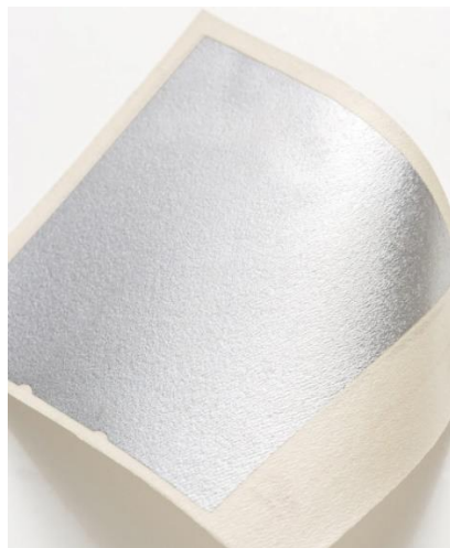
Abb. 2 Die Piezo-Elektret-Folie ist geschäumt und mit Aluminium als Kontaktschicht bedampft. Wird sie durch einwirkende Beschleunigungskräfte verformt, gibt sie Spannung ab, die vom System als Signal aufgenommen wird.
