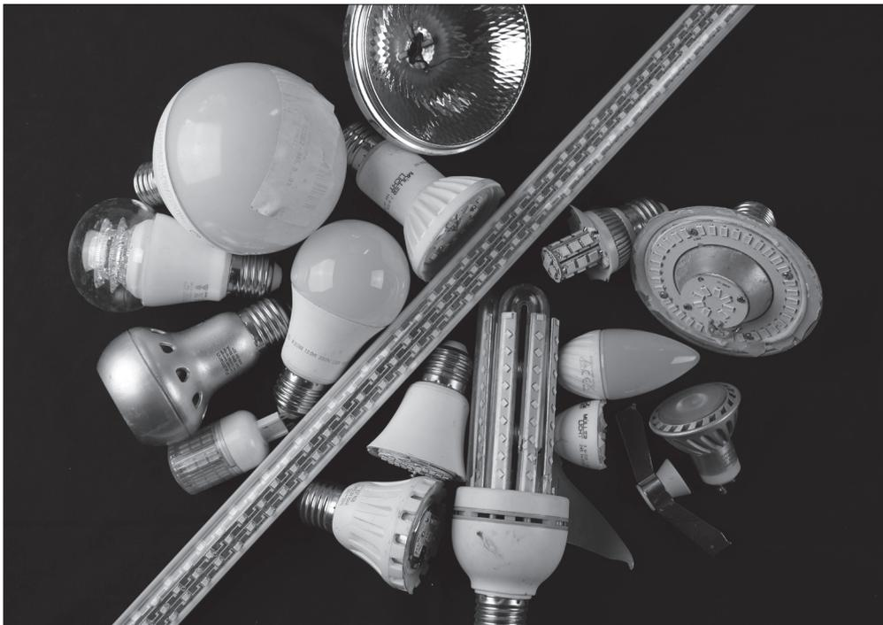
LED-basierte Leuchtmittel gibt es bereits heute in unterschiedlichen Formen. Um sie wirtschaftlich zu recyceln, ist es notwendig, sie zunächst in ihre Einzelteile aufzutrennen. Für das Recycling der LEDs selbst ist es wichtig, diese möglichst unzerstört zu sammeln. (© Fraunhofer ISC/IWKS) | Bild in Farbe und Druckqualität: [www.fraunhofer.de/presse](http://www.fraunhofer.de/presse)
